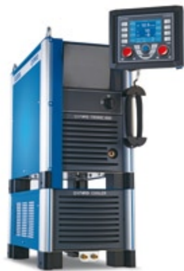
Konfigurationsbeispiel QINEO® TRONIC 450 mit externem Kühlmodul und RPU
